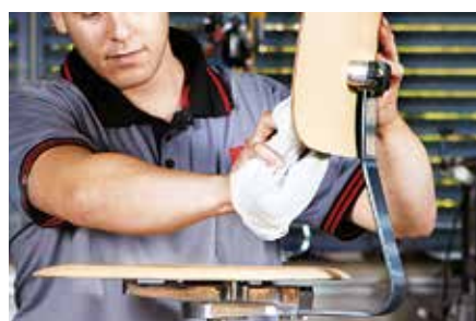
12 Pulizia degli elementi in legno
