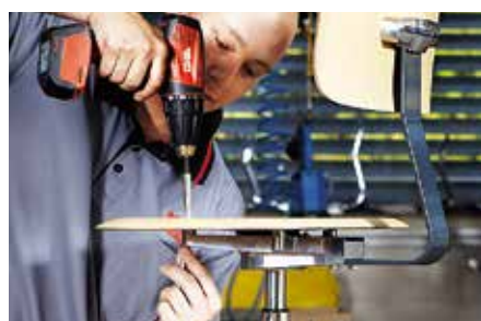
11 Fissaggio del sedile sul supporto
